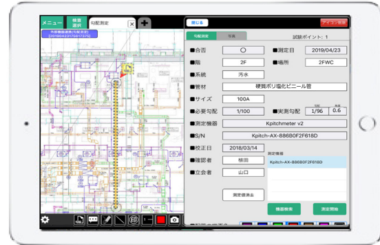
配管勾配測定機能iPad画面
