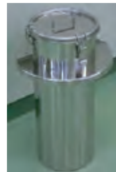
ダストシュート (外した状態)
